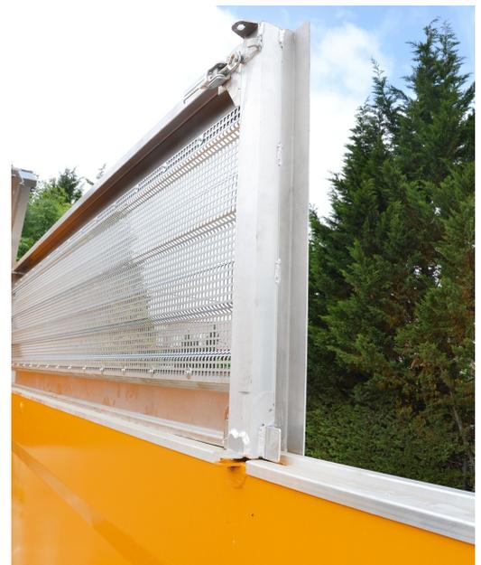
Les six éléments sont posés sur des rails sur toute la longueur du bandeau de la caisse. Des poteaux intermédiaires, auxquels les rehausses sont fixées grâce à plusieurs poignées de fermeture, confèrent la rigidité nécessaire à l'ensemble.
